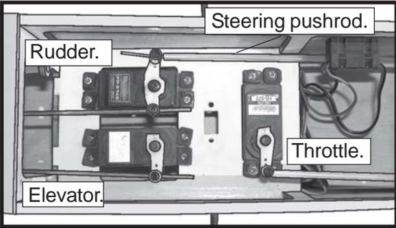
**INSTALLING THE RECEIVER AND BATTERY.**
