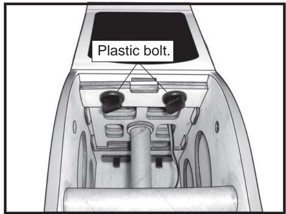
**INSTALLING THE RECEIVER.**
